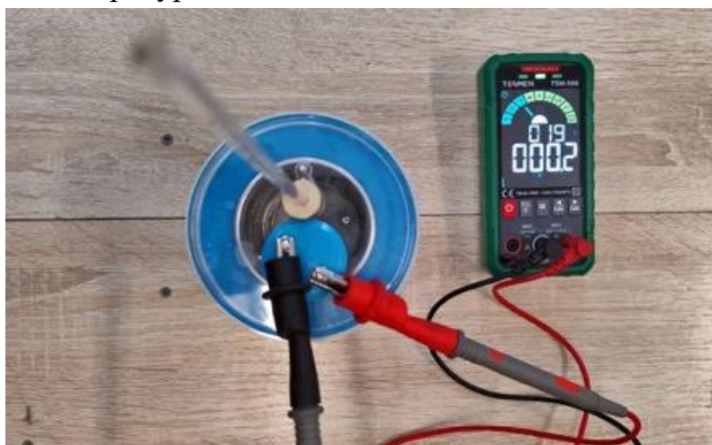
Рис. 1. Измерение начального сопротивления ( R_0 ) образца при комнатной температуре
