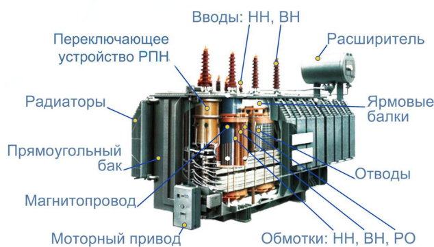
Рис. 6. Устройство трансформатора
